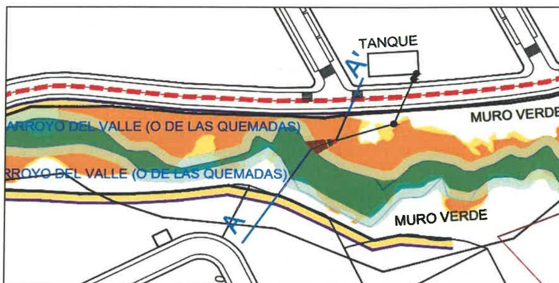
**Ilustración 1.** Disposición en planta del punto de vertido con respecto al dominio público hidráulico y zona de servidumbre del arroyo del Valle. Plano en planta. Fuente: Documentación aportada.
