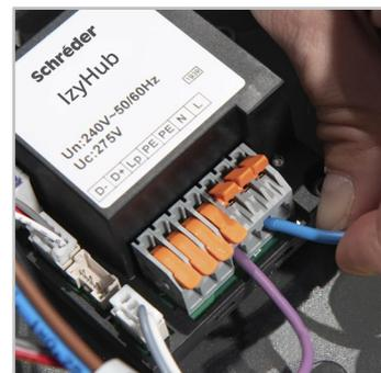
El módulo IzyHub a prueba de fallos facilita la conexión eléctrica en la instalación y durante operaciones de mantenimiento.
