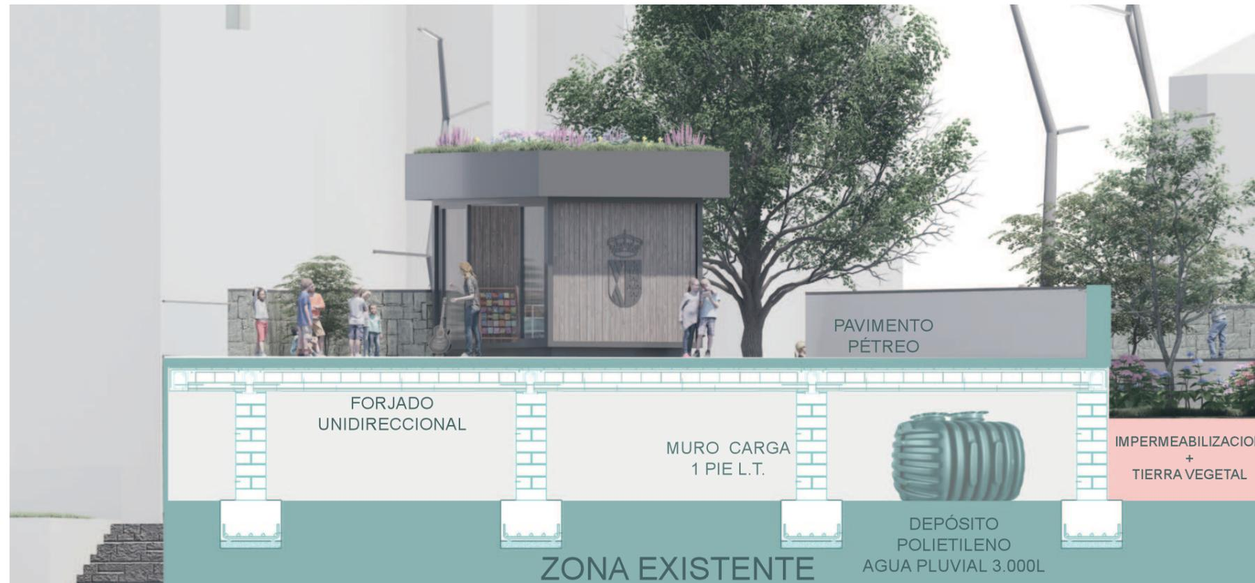
Imagen 23. Sección Constructiva e instalaciones. Elaboración propia
